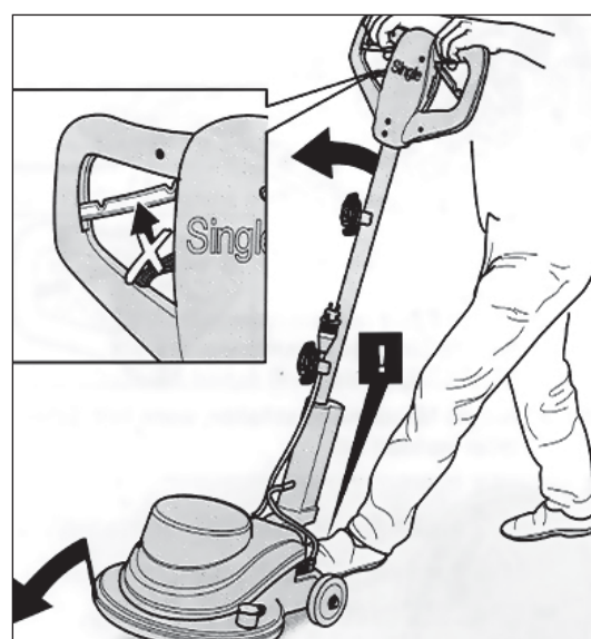
obr. 6 Při zvedání brusky nahoru ji přidržujte zezadu nohou.
