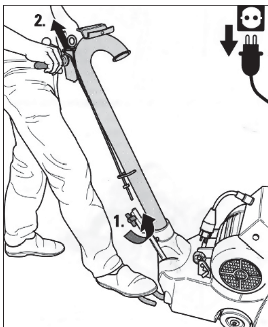
Obr. 17 Po uvolnění křídlového šroubu a matice spouštěcího táhla může být vytažena vodící trubice z objímky skříňe stroje.
