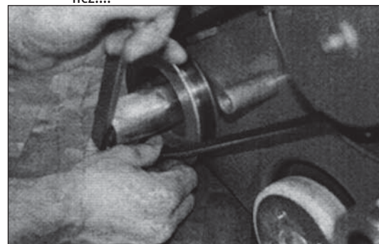
Obr. 46 ...sejmete hnací řemen z řemenice (otáčením hřídele válce ve směru hodinových ručiček).
