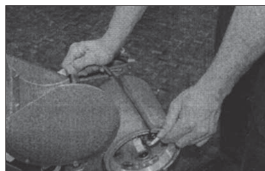
Obr. 17 Po vložení opatrně pootáčte klíči, dokud není brusivo vypnuto, pozor nepřetočit
