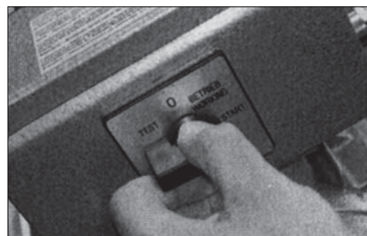
Obr. 12 Pro nastartování pootočíme páčku startéru zcela doprava na dobu ca 2 vteřin do pozice START...
