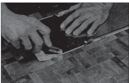
Obr. 8 Kobercovým nožem vyřízneme z pásu brusivo přesně podle šablony.
