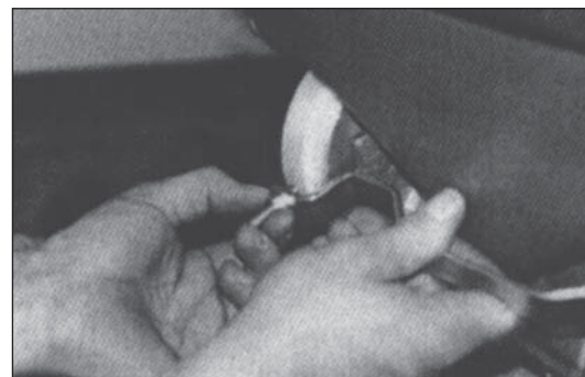
Obr. 30 Seřizovací šablonou změřte nastavení levého kolečka (spodní pohled),...
