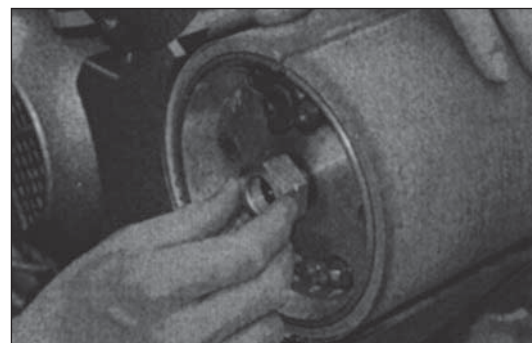
Obr. 37 Pozor levý závit! Opatrně utáhněte. Nepomáhejte si přidržováním z protilehlé strany klínového řemenu.
