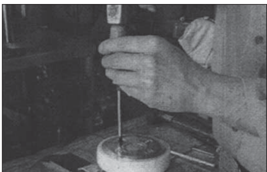
Obr. 42 Zaseknuté šrouby uvolnit lehkým poklepáním kladiva přes šroubovák
