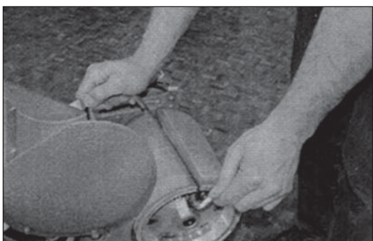
Obr. 9 Rozevřete oběma klíči s vnitřním šestihranem SW 10 upínací drážku a vyjměte staré brusivo...
