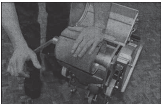
obr. 33 Uvolněte matici válce (pozor levý závit!)
