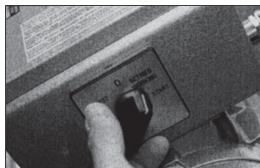
Obr. 13 ...potom páčku pustíme, a ta se sama přepne do polohy PROVOZ (BETRIEB)
